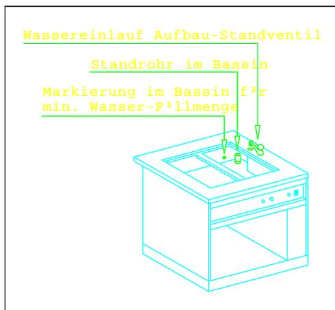
Standrohre auf richtigen Sitz prüfen, dann Heisswasser bis benötigte Höhe einfüllen, (minimaler Wasserstand von 3 cm beachten) siehe Markierungen in den Bassins.
